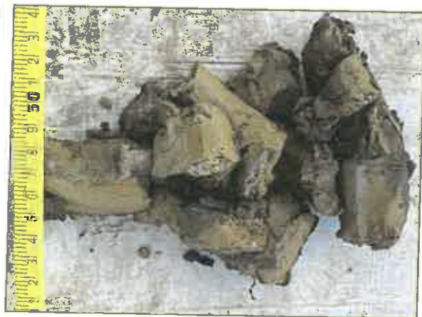
Sol : argile +/- sableuse orangée à beige/grisâtre Tarière T1 - de 0,8 à 1,9 m/TN
