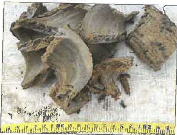
Sol : argile +/- sableuse orangée à beige/grisâtre Tarière T1 - de 1,9 à 3,0 m/TN
