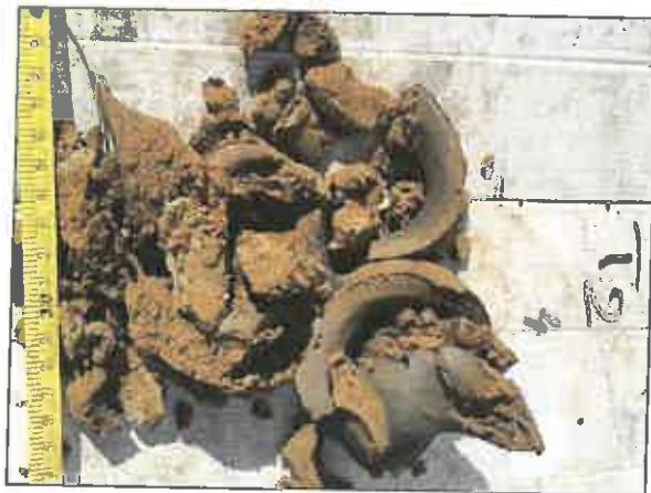
Sol : argile +/- sableuse orangée à beige/grisâtre Tarière T2 - de 1,8 à 3,0 m/TN
