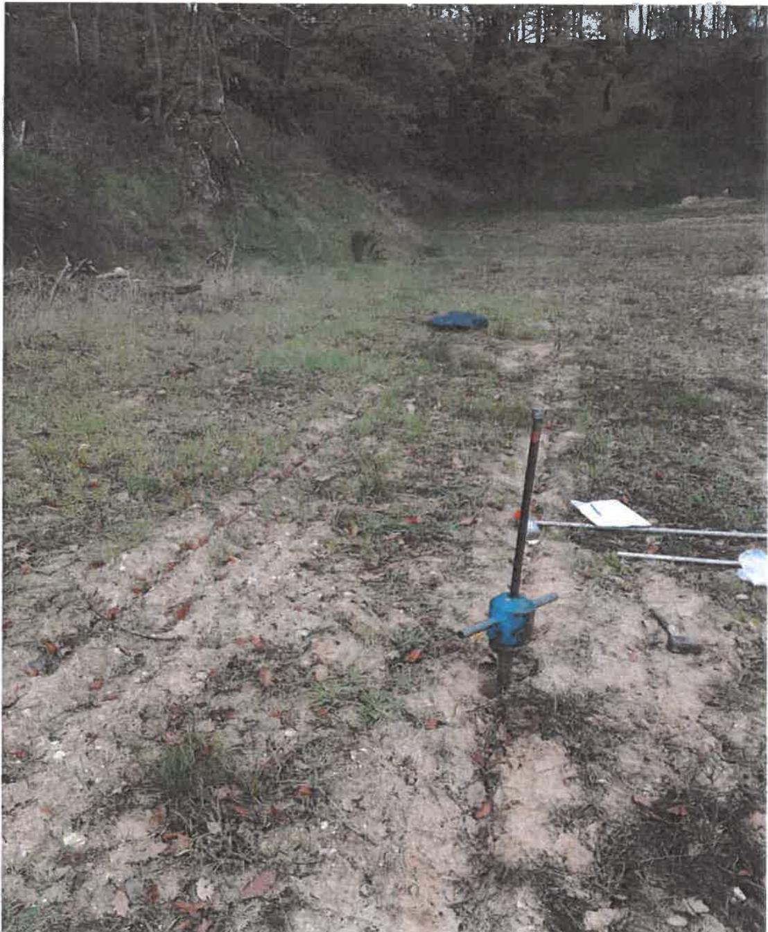
**Photographie du pénétromètre dynamique**
